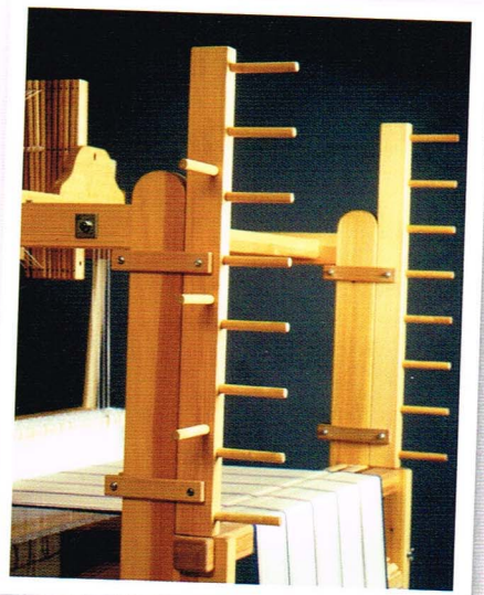
Varpanordning, bak på vävstol
